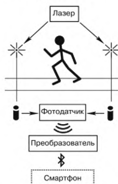
Рисунок 1. Блок-схема устройства экспресс-информации о скорости бега.
