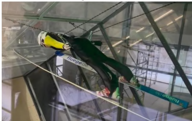
Рисунок 3 – Тренировка в аэродинамической трубе с использованием универсального подвеса (г. Пермь)
