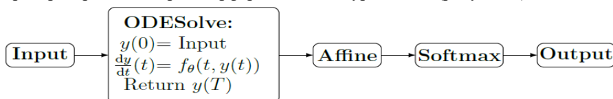
Рисунок 2 – Схема определения обучаемых параметров НС с использованием оператора решения дифференциального уравнения
